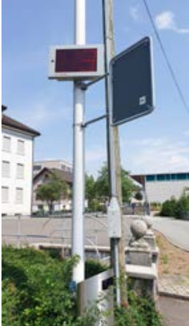
Geschwindigkeitsmessanlage beim alten Feuerwehrdepot an der Schulhausstrasse.
