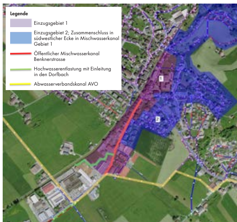
Übersicht bestehendes Abwassersystem
