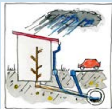
Darstellung eines Mischsystems
